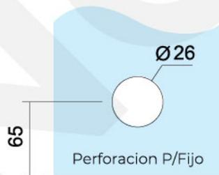
La altura de las perforaciones para los conectores a vidrios para fijos, se calcula de la siguiente manera:
